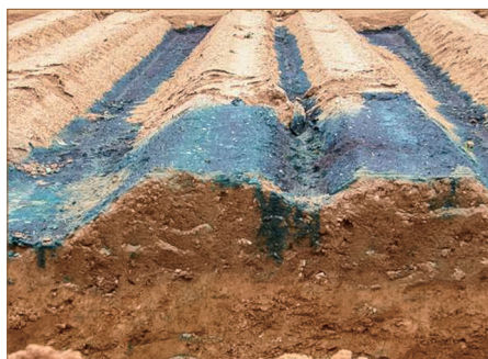
Vsakování vody po simulaci srážek – miskovitý tvar hrůbků
