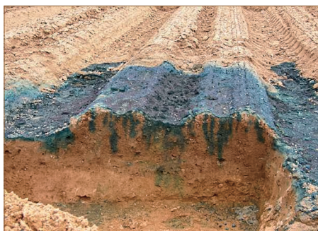
Vsakování vody po simulaci srážek – kypření před začátkem vzcházení
