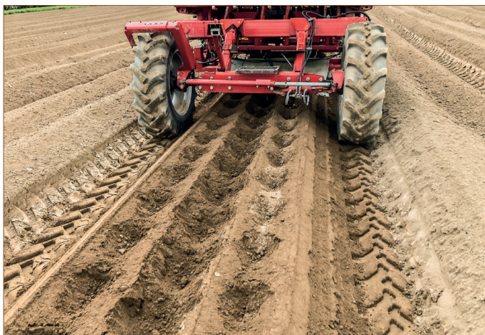
Důlky a hrázky vytvořené modulátorem hrůbků umístěným na sazeči
